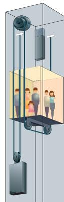
Todo el equipo está instalado en el pozo del ascensor. Sin la sala de máquinas, el espacio en el pozo le da a los arquitectos y diseñadores de interiores mayor libertad de diseño.
